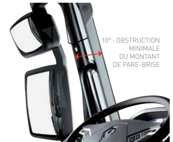
RÉTROVISEURS GRAND ANGLE ET PRINCIPAL réglables électriquement, chauffants et dégivrants.
