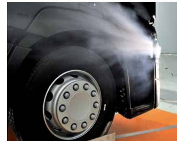
SOUFFLERIE pour mesurer la pénétration de la cabine dans l'air.
