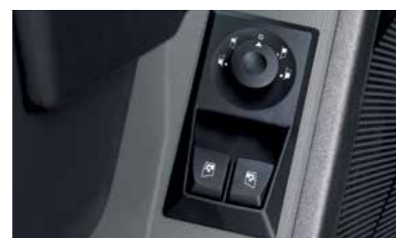
GESTION DES VITRES ET RÉTROVISEURS LATÉRAUX avec lève-vitre impulsif et réglage électrique des rétroviseurs principaux et grand angle.
