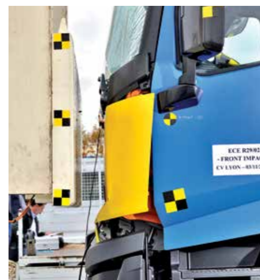
CHOC FRONTAL pour mesurer la résistance de la cabine à l'impact.
