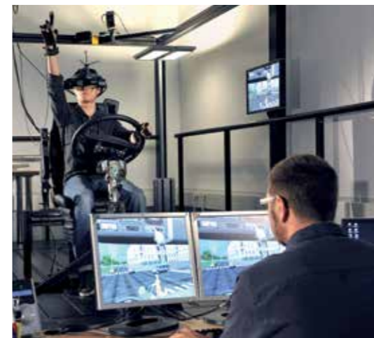
RÉALITÉ VIRTUELLE pour optimiser l'ergonomie du poste de conduite.
