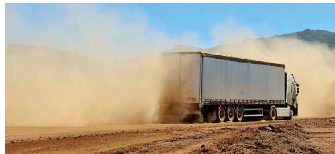
TEST TEMPÉRATURES EXTRÊMES à Almeria (Espagne) pour mesurer la résistance du véhicule en conditions difficiles (poussière, chaleur, etc.).
